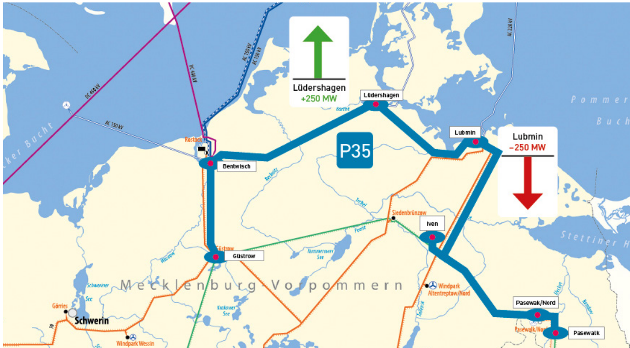
Abbildung 25: Verschiebung der Anschlusskapazität von Netzverknüpfungspunkt Lubmin auf Netzverknüpfungspunkt Lüdershagen
