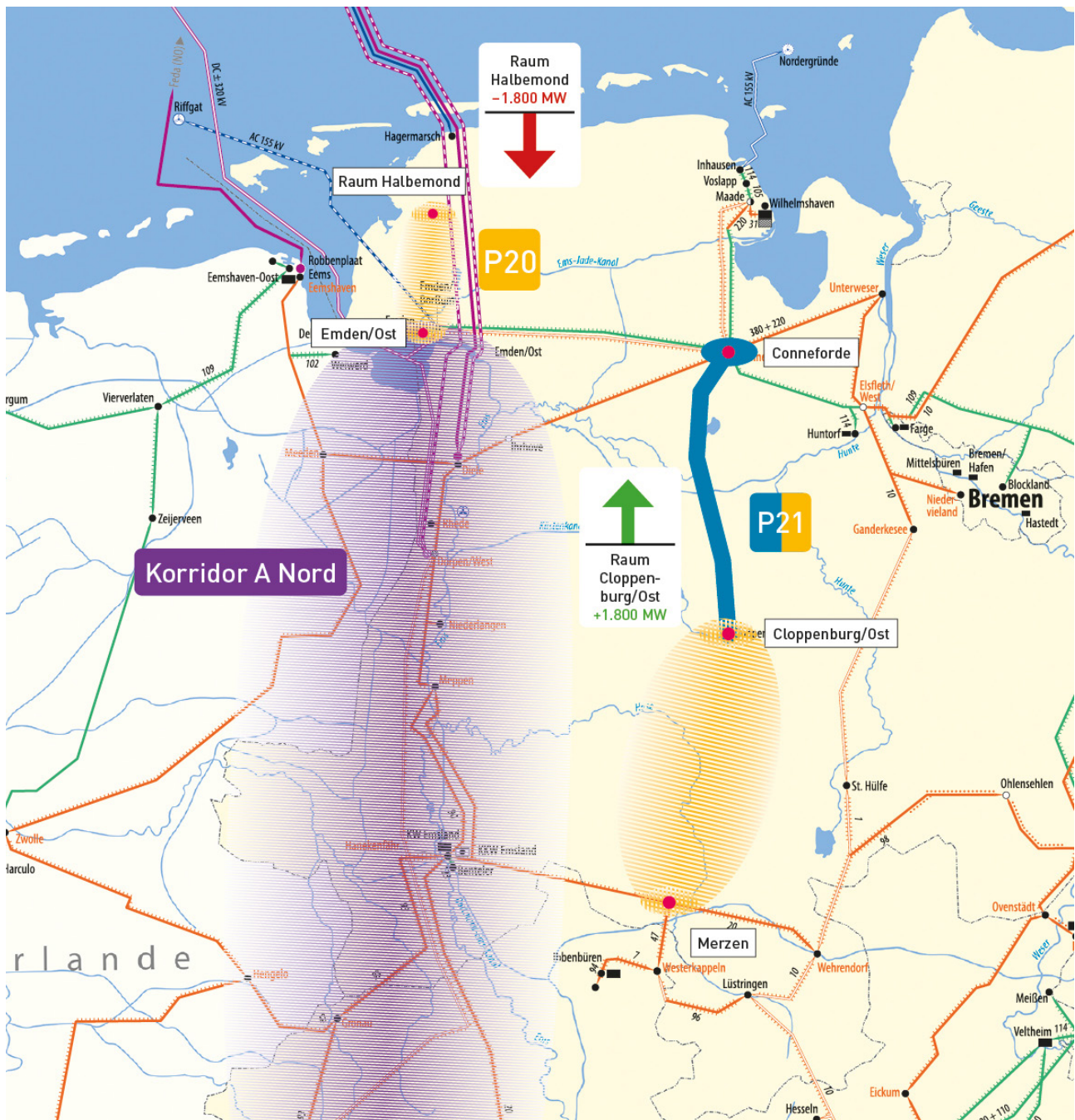
Abbildung 24: Verschiebung der Netzverknüpfungspunkte im Szenario B 2024* von Raum Halbmond und Raum Cloppenburg/Ost
